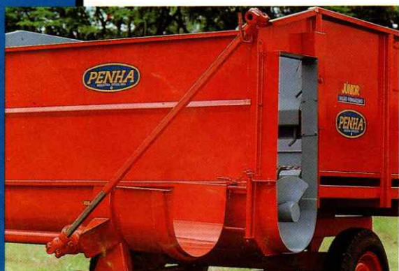
Engate da TDF (Tomada de Força) e prolongador de descarga basculante.
