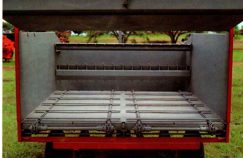
Esteiras rolantes do Vagão vistas através da tampa basculante traseira aberta.
