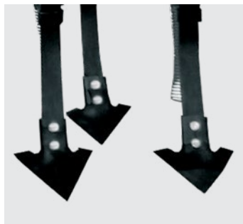
Enxadas em aço de alta resistência. Steel sweeps of high resistance. Azadas de acero templado.
